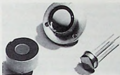
Rechts: thermistor 8 mm \phi , links bevestigingsmateriaal
